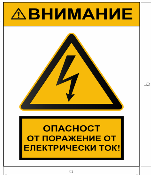
Фиг. 14 Табела „Внимание! Опасност от поражение от електрически ток!”
